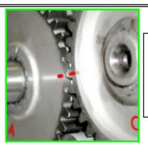
**4-** CHECK THAT THE GEARS SURFACES ARE ON THE SAME PLANE.
