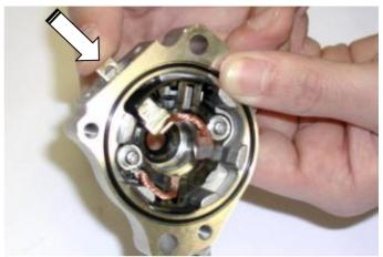
INSTALL NEW BRUSH TERMINAL INSIDE REINSTALL THE PLATE AND FIXE IT PLACE LITTLE RUBBER CAP ON THE WITH THE 2 SCREWS M4 TERMINAL. (PHILLIPS SCREWDRIVER)
